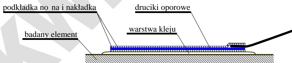
Rys. 3. Sposób naklejenia czujnika tensometrycznego
