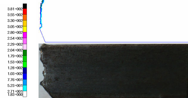
Rys. 5 Graficzne porównanie powierzchni pęknięcia uzyskanego w symulacji numerycznej i doświadczeniu
