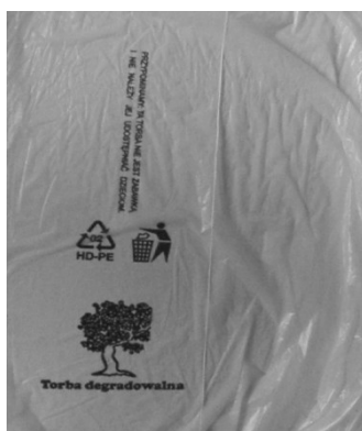
Rys. 14.6 Torba handlowa z cienkiej folii PE-HD z symbolem drzewka i napisem „torba degradowalna”
