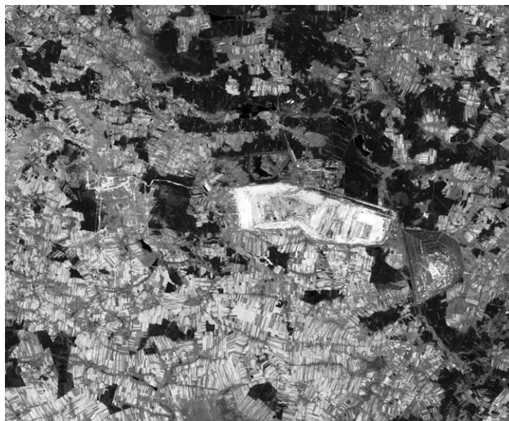
Rys. 1.3 Kompozycja barwna RGB (po desaturacji koloru) z pasm 4, 7 i 2 zdjęcia Landsat ETM+ z dnia 24.08.2002r przedstawiająca obszar wokół KWB Bełchatów
