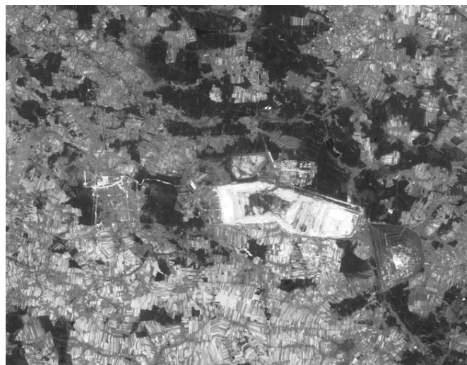
Rys. 1.2 Kompozycja barwna RGB (po desaturacji koloru) z pasm 4, 3 i 2 zdjęcia Landsat ETM+ z dnia 24.08.2002 r. przedstawiająca obszar wokół KWB Bełchatów
