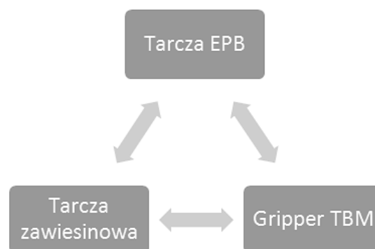
Rys. 26.4. Schematyczna możliwość łączenia dwóch trybów pracy kombajnu pełoprzekrojowego
