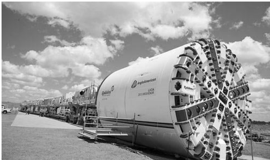
Rys. 26.9 Schemat i widok kombajnu pełnoprzekrojowego zamkniętego typ EPB firmy Robbins wykorzystanego do drażnienia upadowej w projekcie Grosvenor
