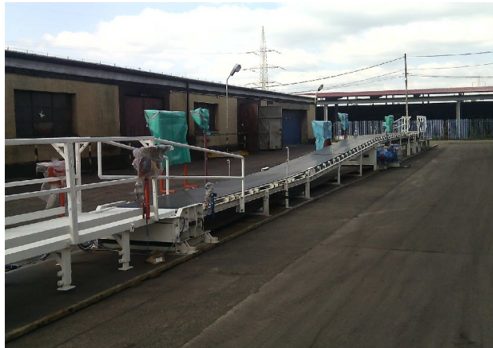
Rys. 53.6 Mechaniczne Urządzenie dla Lokalnego, rewersyjnego przemieszczania załogi Źródło: własne
