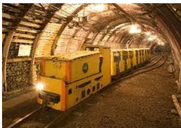
Rys. 53.1 Zestaw kolei podziemnej do przewozu pracowników
