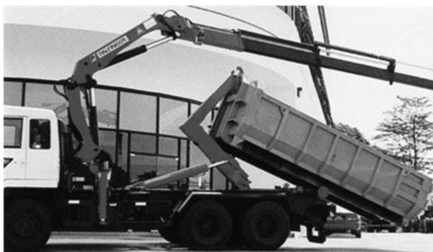
Rys. 22.1 Żuraw przenośny i dźwignik hakowy kontenerowy na podwoziu samochodu ciężarowego (zestaw firmy Palfinger A.G. – Austria)
