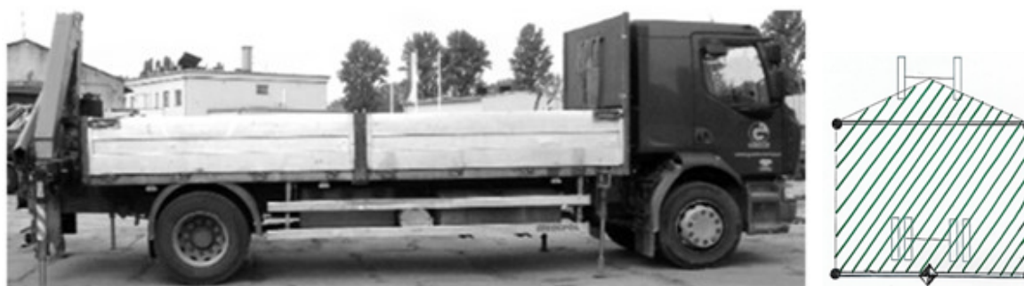
Rys. 22.11 Żuraw z zabudową za skrzynią ładunkową i dodatkowymi podporami z przodu oraz jego kontur wywrotu
