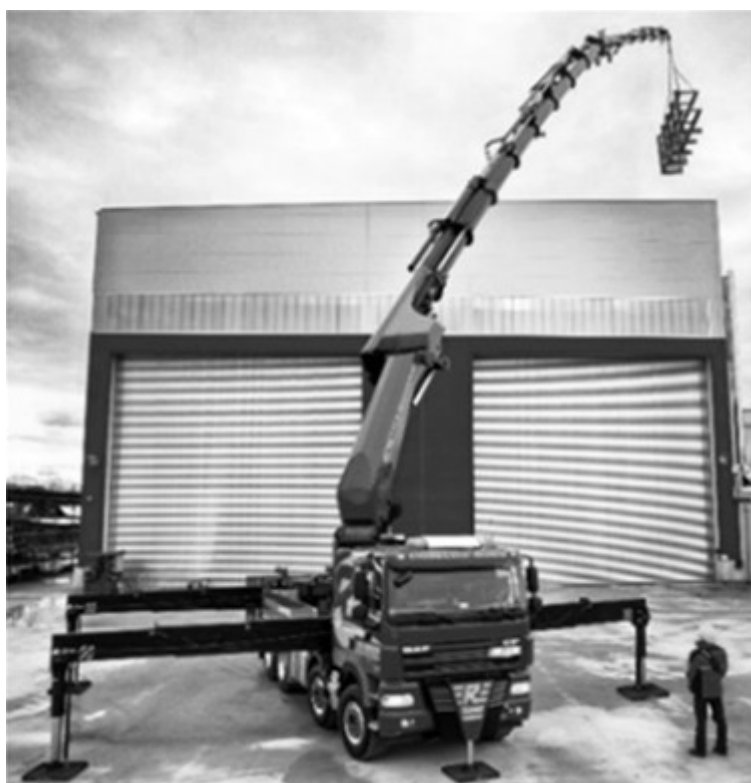
Rys. 22.12 Żuraw montowany za kabiną z dodatkowymi podporami pod skrzynią ładunkową i podporą z przodu samochodu oraz jego kontur wywrotu
