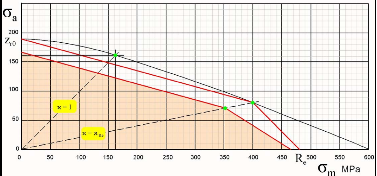
Rys. 6 Skorygowany wykres Sorensen'a dla naprężeń krytycznych elementu; Obszar naprężeń dopuszczalnych zacieniowany.
