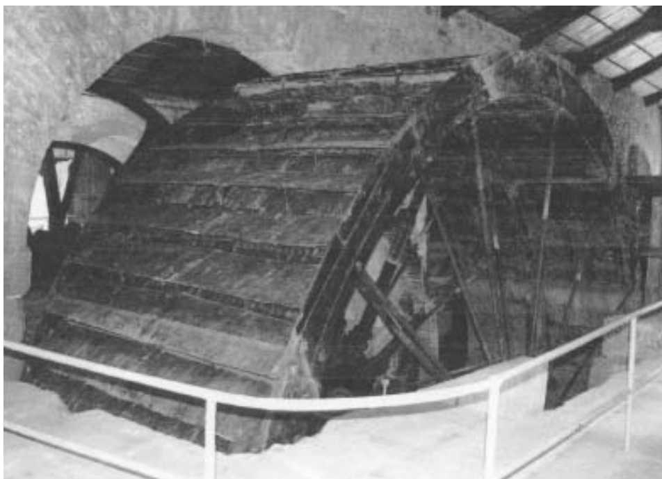
Rys. 3. Koło wodne w Muzeum Techniki w Sielpi D=9,6 m, P=50 kW
