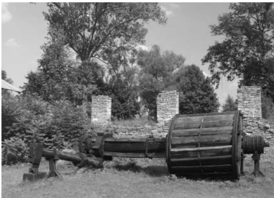
Rys. 1. Koło wodne stosowane do napędu młota pudlingowego w Sielpii Wielkiej
